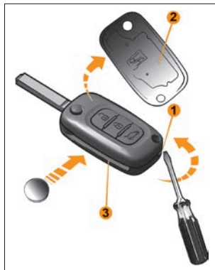
Рис. 10. Замена элемента питания пульта дистанционного управления
