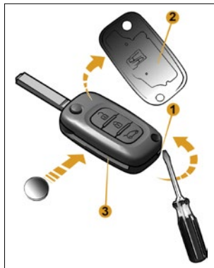
Рис. 10. Замена элемента питания пульта дистанционного управления
