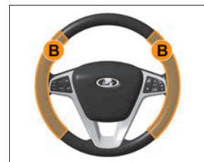
Рис. 2д. Зоны максимального обогрева рулевого колеса (в варианном исполнении)
