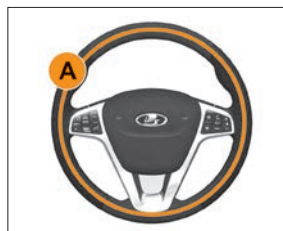
Рис. 2г. Зоны обогрева рулевого колеса (в варианном исполнении)
