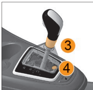
Рис. 21. Снятие блокировки рычага переключения передач
