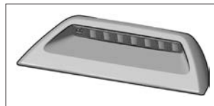
Рис. 15. Дополнительный сигнал торможения (кузов «SE»)
