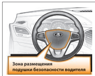
Рис. 4. Место установки фронтальной подушки безопасности водителя
