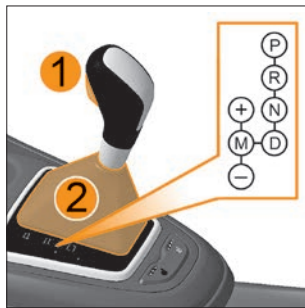
Рис. 20. Рычаг переключения передач автоматической коробки передач
