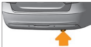
Рис. 10. Расположение задней буксирной проушины (в варианте исполнения)
