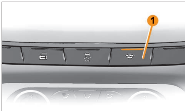
Рис. 7. Кнопка включения электрического обогрева ветрового стекла (в варианном исполнении)
