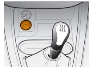
Рис. 2. Розетка для подключения дополнительного электрооборудования
