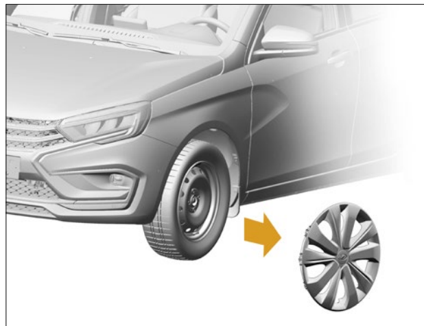
Рис. 6.8.4. Снятие декоративного колпака (в варианном исполнении)
