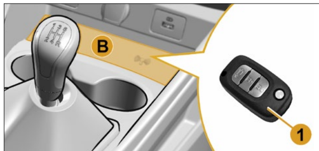
Рис. 5.10.2. Место размещения считывающего устройства
