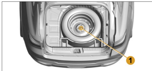
Рис. 6.8.3. Винт крепления запасного колеса
