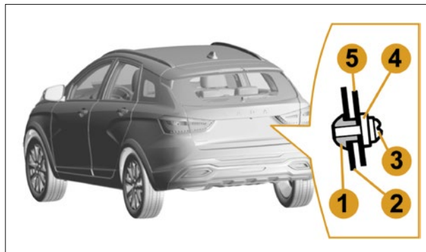
Рис. 5.1.2. Установка заднего номерного знака
