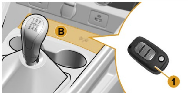
Рис. 3.5.3. Место размещения считывающего устройства
