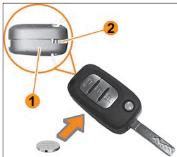
Рис. 8.10. Замена элемента питания ПДУ
