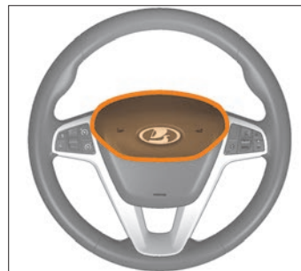
Рис. 3.10. Активация звукового сигнала
