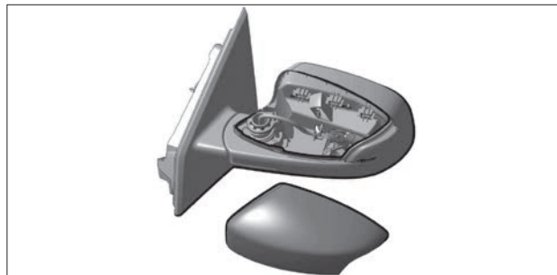
Рис. 8.19. Снятие накладки зеркала
