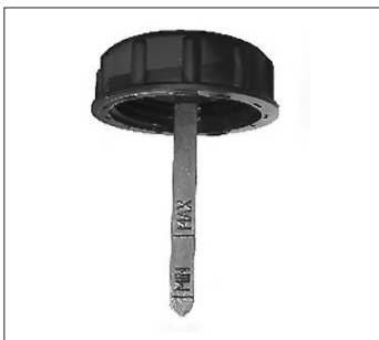
Рис. 8.7.2. Крышка бачка гидроусилителя рулевого управления со щупом
