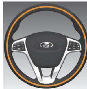
Рис. 3.11.4. Зоны обогрева рулевого колеса (в варианном исполнении)
