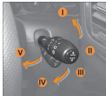
Рис. 1.30. Положения рычага управления омывом и очисткой стекол
