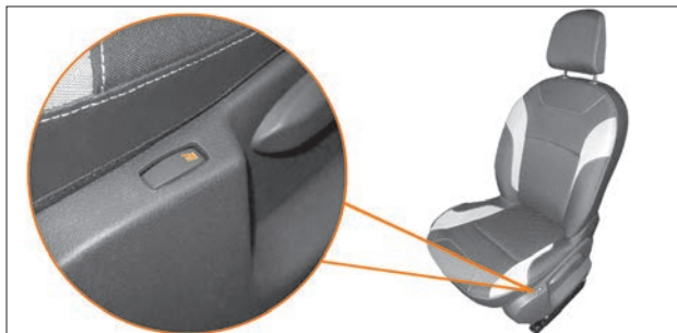
Рис. 2.4.1. Выключатель подогрева передних сидений (с фиксированными положениями)
