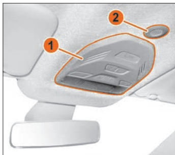
Рис. 7.2а. Общий вид блока освещения салона
