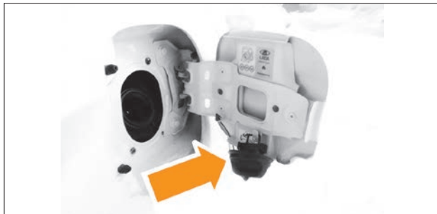
Рис. 4.9. Расположение пробки топливного бака при заправке
