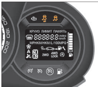
Рис. 4.6.2. Сигнализаторы «ESC» и «ESC OFF»
