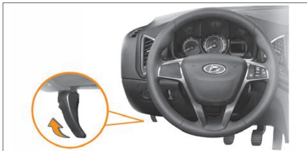
Рис. 8.1. Рукоятка отпирания капота
