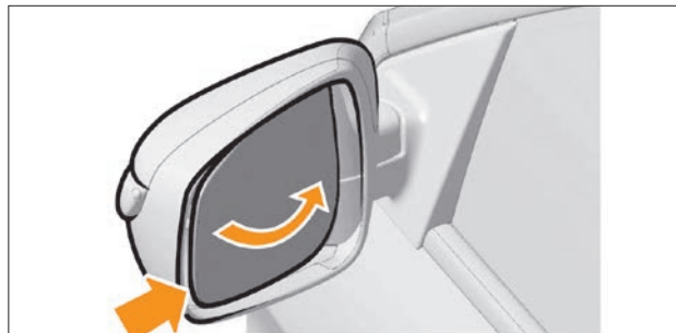
Рис. 8.15. Зеркальный элемент в максимальном боковом положении
