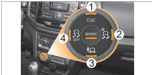
Рис. 4.7. Переключатель режимов движения системы электронного контроля устойчивости (в вариантном исполнении)
