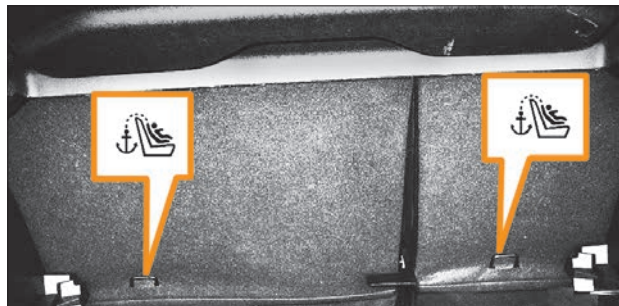
Рис. 2.18. Кронштейны для верхнего страховочного ремня ISOFIX
