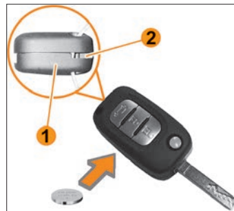
Рис. 8.10. Замена элемента питания ПДУ
