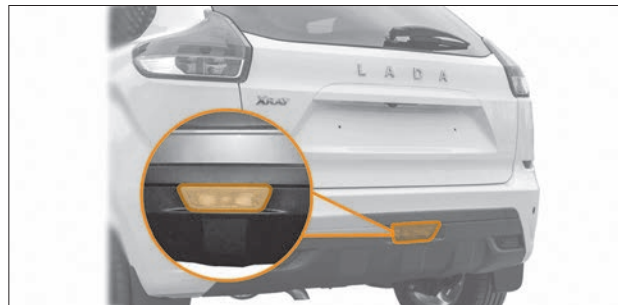
Рис. 8.14. Задний противотуманный фонарь
