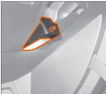
Рис. 7.3. Плафон освещения вещевого ящика
