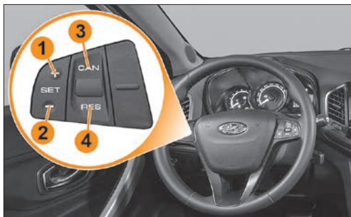
Рис. 5.1. Блок управления системами «Круиз-контроль» и «Ограничитель скорости» на рулевом колесе
