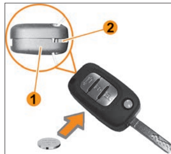
Рис. 8.10. Замена элемента питания ПДУ
