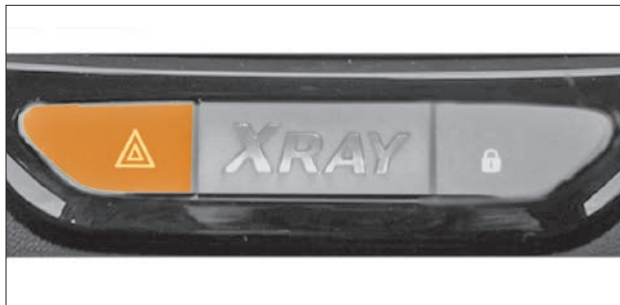
Рис. 1.12. Кнопка аварийной световой сигнализации
