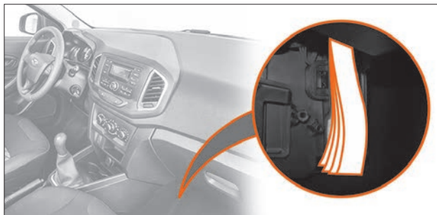
Рис. 6.5. Замена фильтра салона
