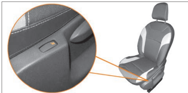
Рис. 2.4. Выключатель подогрева передних сидений (с фиксированными положениями)
