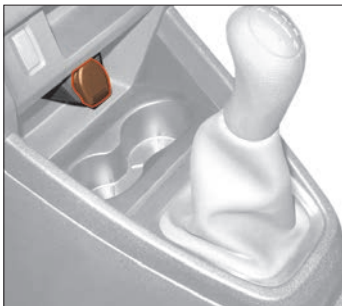
Рис. 7.5. Розетка для подключения дополнительного электрооборудования
