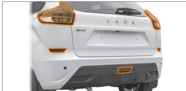
Рис. 9.12. Рассеиватели световых приборов задние
