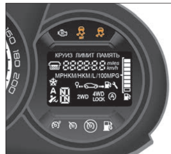
Рис. 4.7. Сигнализаторы «ESC» и «ESC OFF»
