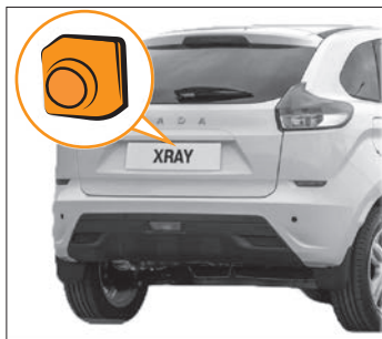
Рис. 5.6. Камера заднего вида
