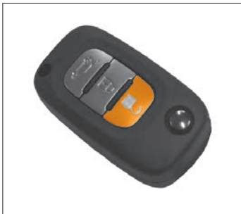
Рис. 1.3. Кнопка «РАЗБЛОКИРОВКА» пульта дистанционного управления
