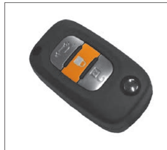
Рис. 1.4 Кнопка «БЛОКИРОВКА» пульта дистанционного управления
