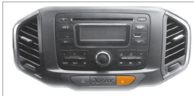
Рис. 1.10. Кнопка выключателя блокировки двери
