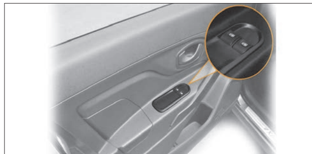
Рис. 1.18. Блок переключателей на двери водителя
