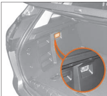
Рис. 7.4. Плафон освещения багажного отделения
