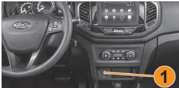
Рис. 4.6. Выключатель «ESC OFF»
