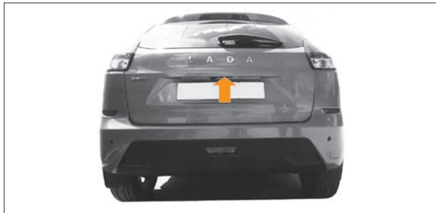
Рис. 1.9. Кнопка открывания двери задка
