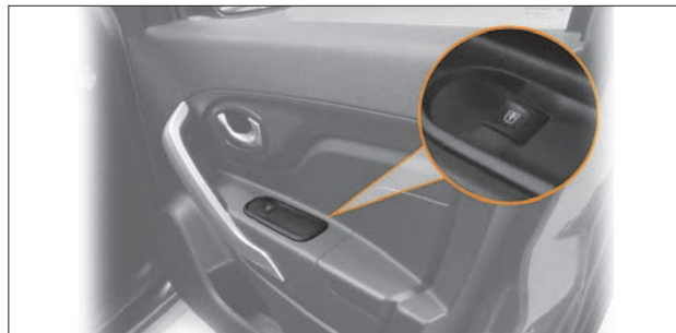
Рис. 1.21. Кнопка управления электрическим стеклоподъемником двери переднего пассажира
