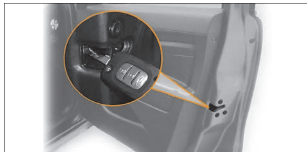
Рис. 1.16. Рычаг для запираения двери при деактивированных электрических приводах замков
