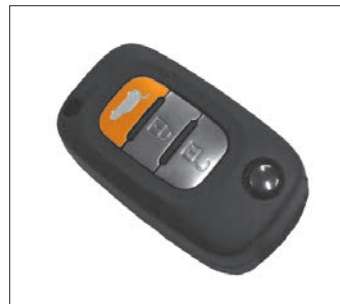
Рис. 1.5. Кнопка открывания двери задка пульта дистанционного управления
