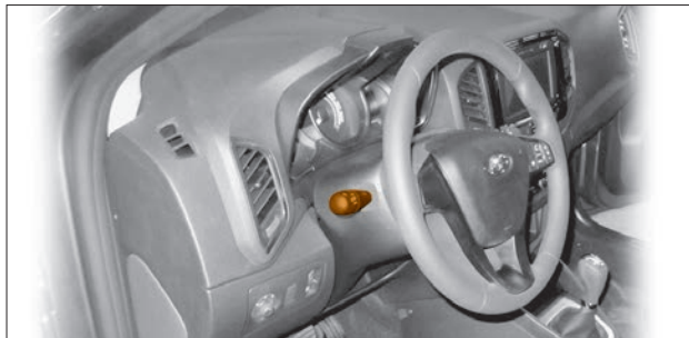
Рис. 1.24. Переключатель световой сигнализации
