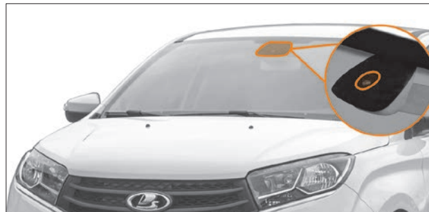
Рис. 1.28. Датчик дождя и света
