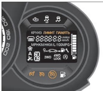
Рис. 5.3. Дисплей комбинации приборов
