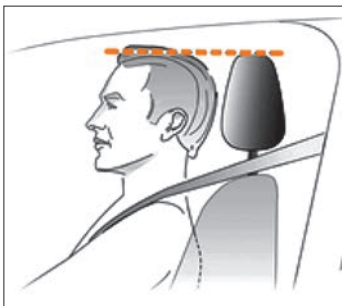
Рис. 2.6. Оптимальное положение переднего подголовника
