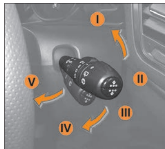
Рис. 1.30. Положения рычага управления омывом и очисткой стекол
