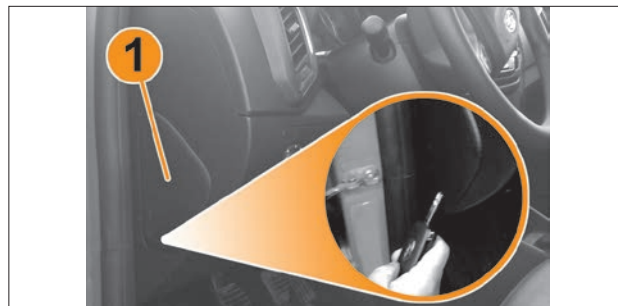
Рис. 8.29 Демонтаж крышки блока предохранителей и реле салона
