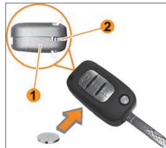
Рис. 8.10. Замена элемента питания ПДУ
