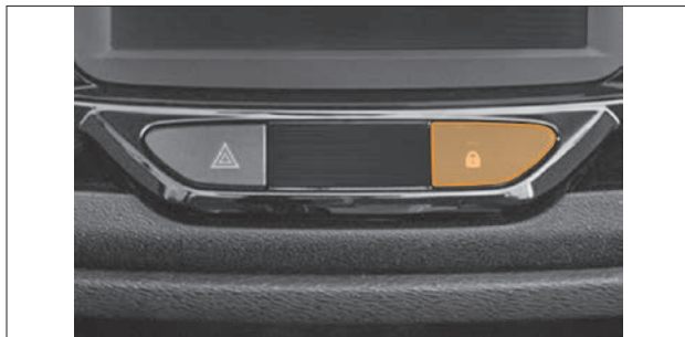
Рис. 1.10. Кнопка выключателя блокировки дверей
