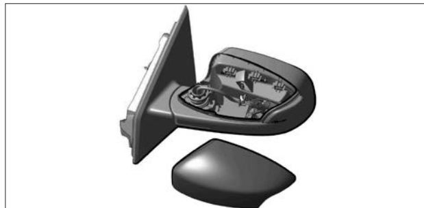
Рис. 8.19. Снятие накладки зеркала
