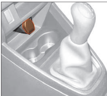
Рис. 7.5. Розетка для подключения дополнительного электрооборудования
