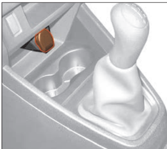
Рис. 7.5. Розетка для подключения дополнительного электрооборудования
