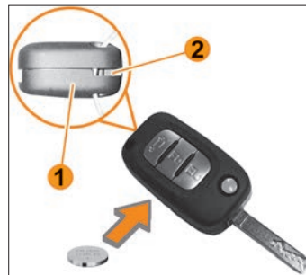
Рис. 8.10. Замена элемента питания ПДУ
