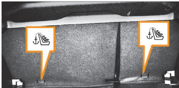
Рис. 2.17. Кронштейны для верхнего страховочного ремня ISOFIX
