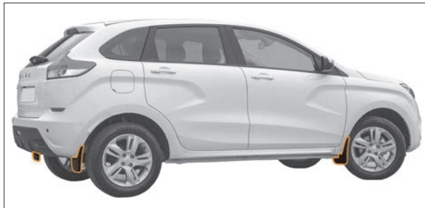
Рис. 8.31. Щитки переднего и заднего крыла
