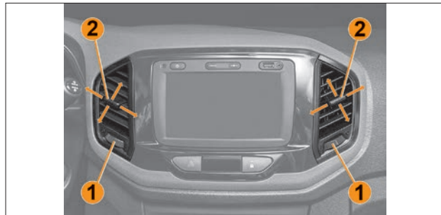
Рис. 6.2. Регулировка воздушных потоков через вентиляционные сопла
