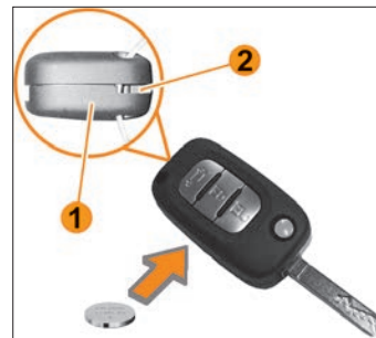
Рис. 8.10. Замена элемента питания ПДУ
