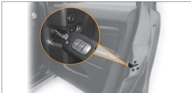
Рис. 1.16. Рычаг для запираания двери при деактивированных электрических приводах замков
