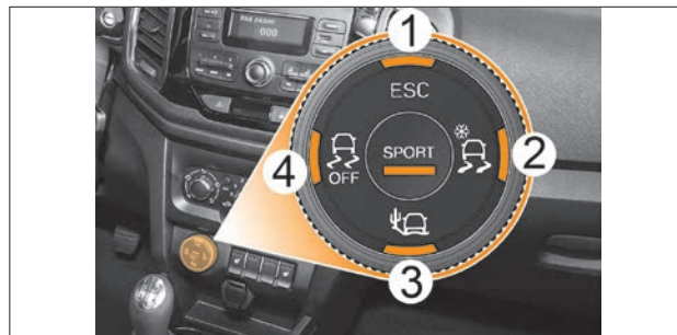
Рис. 4.7. Переключатель режимов движения системы электронного контроля устойчивости (в варианном исполнении)
