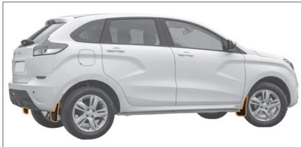
Рис. 8.30. Щитки переднего и заднего крыла
