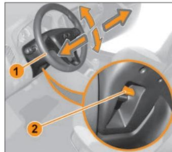
Рис. 3.9.2. Регулировка положения рулевого колеса (в варианном исполнении)
