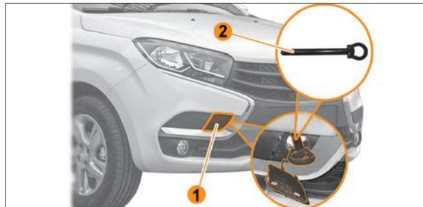
Рис. 9.6. Расположение передней буксирной проушины (в варианте исполнения)
