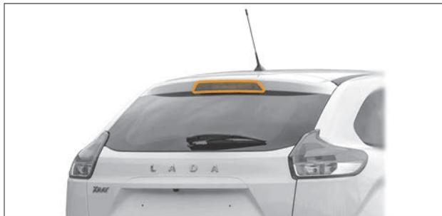
Рис. 8.23. Дополнительный сигнал торможения
