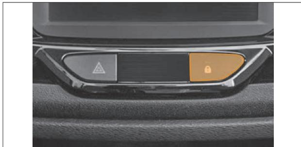
Рис. 1.10. Кнопка выключателя блокировки дверей
