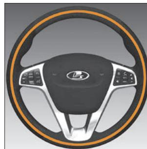
Рис. 3.11.4. Зоны обогрева рулевого колеса
