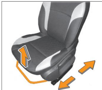
Рис. 2.1. Регулировка положения переднего сиденья
