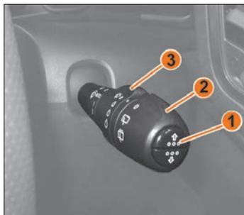
Рис. 1.29. Рычаг управления омывом и очисткой стекол
