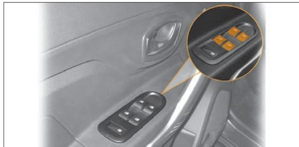
Рис. 1.19. Блок переключателей на двери водителя (в варианном исполнении)
