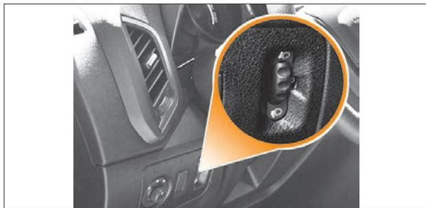
Рис. 3.15. Колесико переключателя электрокорректора угла наклона света фар
