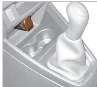
**Рис. 7.5.1. Розетка для подключения дополнительного электрооборудования**
