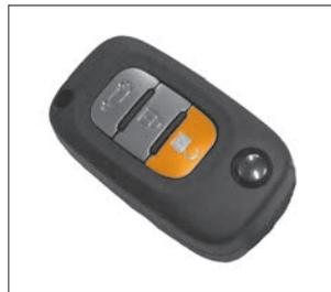
Рис. 1.3. Кнопка «РАЗБЛОКИРОВКА» пульта дистанционного управления
