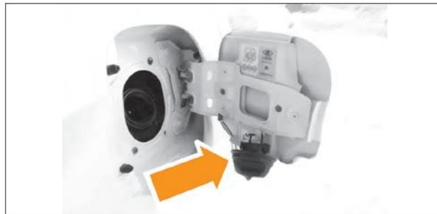
Рис. 4.9. Расположение пробки при заправке (в варианном исполнении)
