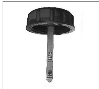
Рис. 8.7.2. Крышка бачка гидроусилителя рулевого управления со щупом
