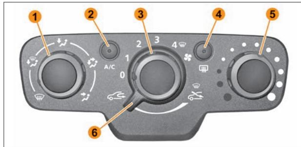
Рис. 6.3. Панель управления климатической системой с ручным управлением
