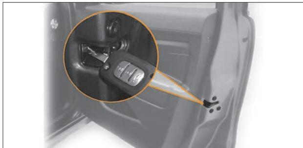
Рис. 1.16. Рычаг для заперения двери при деактивированных электрических приводах замков
