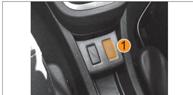
Рис. 4.6.3. Выключатель «ESC OFF» на тоннеле пола (в варианном исполнении)
