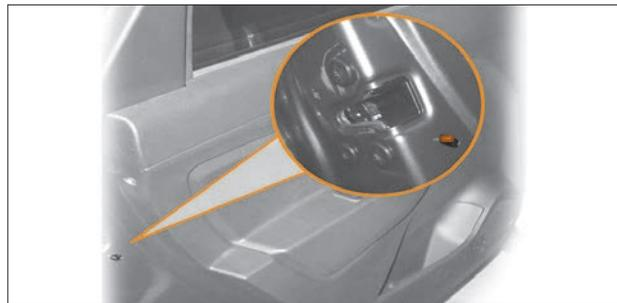
Рис. 1.17. Рычаг для блокировки открывания задней двери изнутри (детская блокировка)
