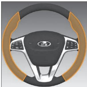
Рис. 3.11.5. Зоны максимального обогрева рулевого колеса
