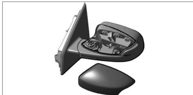
Рис. 8.19. Снятие накладки зеркала
