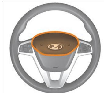
Рис. 3.10. Активация звукового сигнала
