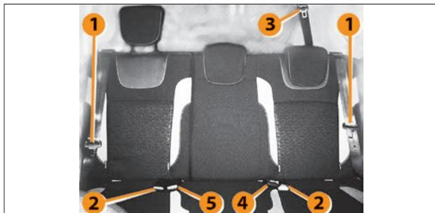
Рис. 2.10. Задние ремни безопасности
