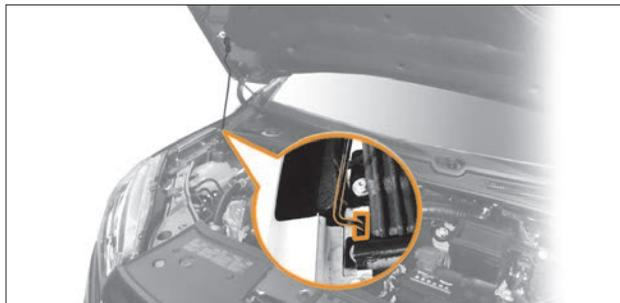
Рис. 8.3.1. Упор капота
