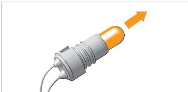
Рис. 8.21. Извлечение лампы
