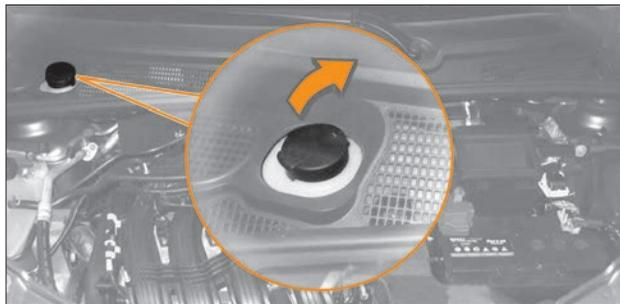
Рис. 8.8. Бачок стеклоомывателя
