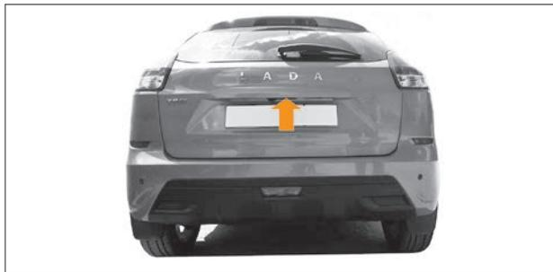
Рис. 1.9. Кнопка открывания двери задка
