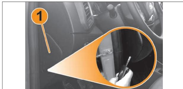
Рис. 8.29 Демонтаж крышки блока предохранителей и реле салона
