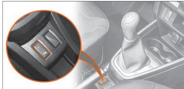
Рис. 5.6. Выключатель СБП
