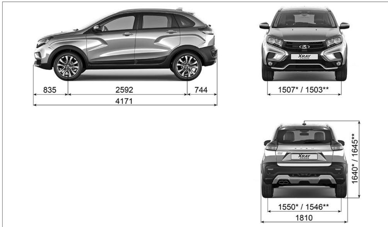
Рис. 10.4. Габаритные (справочные) размеры автомобиля XRAY Cross
