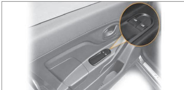
Рис. 1.18. Блок переключателей на двери водителя
