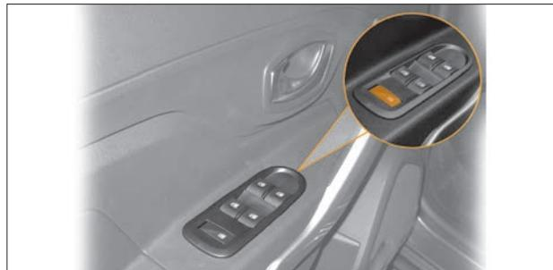
Рис. 1.20. Кнопка блокировки стеклоподъемников задних дверей (в варианном исполнении)
