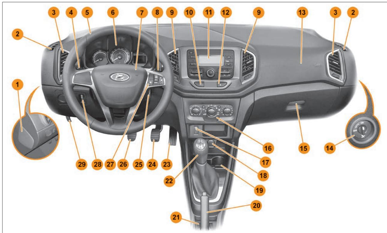
Рис. 3.1.1. Органы управления и приборы автомобиля XRAY
