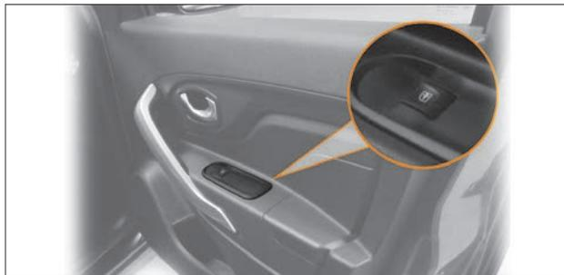
Рис. 1.21. Кнопка управления электрическим стеклоподъемником двери переднего пассажира
