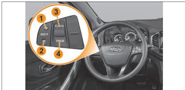
Рис. 5.1. Блок управления системами «Круиз-контроль» и «Ограничитель скорости» на рулевом колесе
