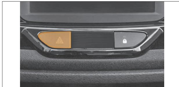
Рис. 1.12. Кнопка выключателя аварийной световой сигнализации
