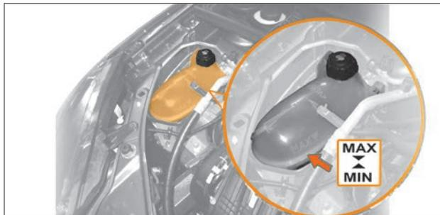
Рис. 8.6. Расширительный бачок
