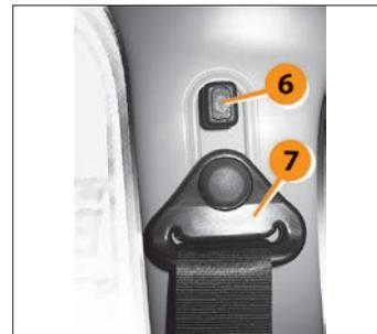
Рис. 2.11. Регулировка переднего ремня безопасности
