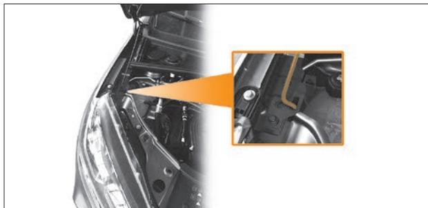
Рис. 8.3.2. Упор капота
