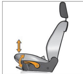
Рис. 2.3.1. Регулировка сиденья по высоте
