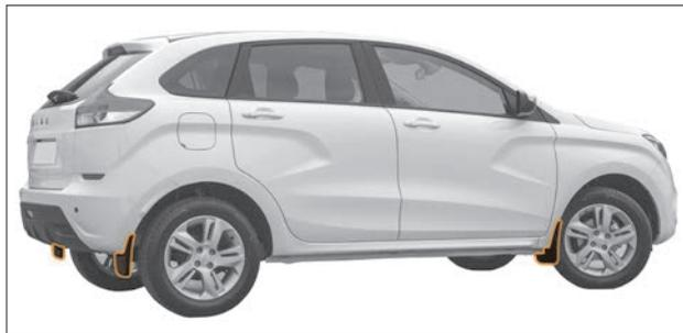
Рис. 8.30. Щитки переднего и заднего крыла
