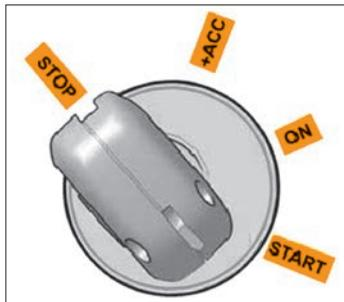
Рис. 1.7. Выключатель зажигания
