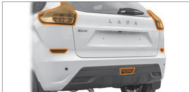
Рис. 9.11. Рассеиватели световых приборов задние
