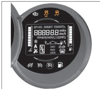
Рис. 4.6.2. Сигнализаторы «ESC» и «ESC OFF»
