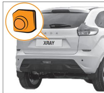
Рис. 5.7. Камера заднего вида
