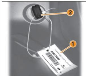
Рис. 1.6. Съемная бирка с номером кода ключа
