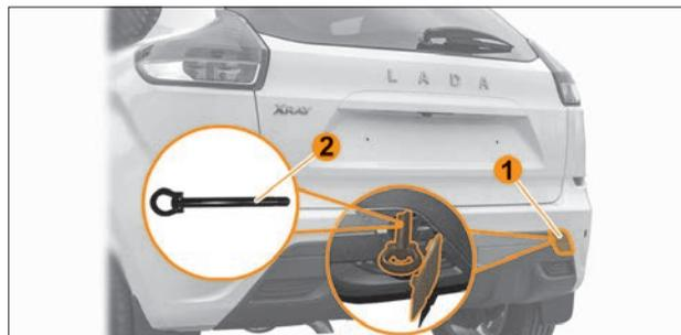
Рис. 9.7. Расположение задней буксирной проушины (в варианте исполнения)
