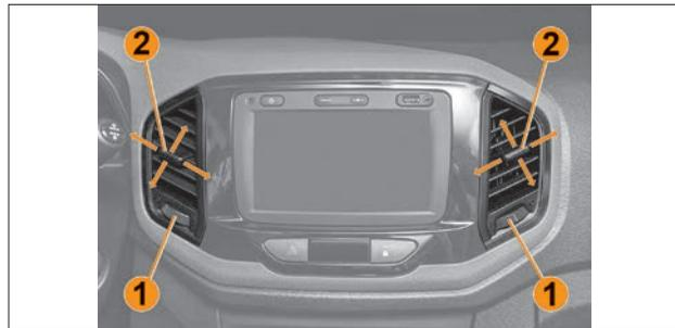
Рис. 6.2. Регулировка воздушных потоков через вентиляционные сопла
