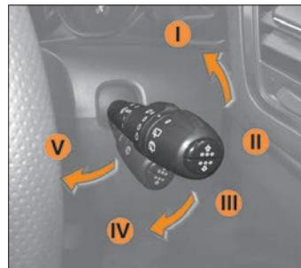
Рис. 1.30. Положения рычага управления омывом и очисткой стекол
