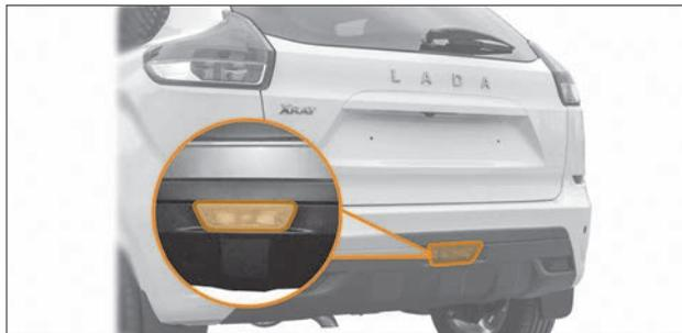
Рис. 8.14. Задний противотуманный фонарь
