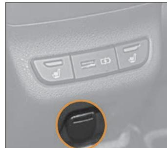
Рис. 7.5.2. Розетка для подключения дополнительного электрооборудования на центральном подлокотнике (в варианном исполнении)
