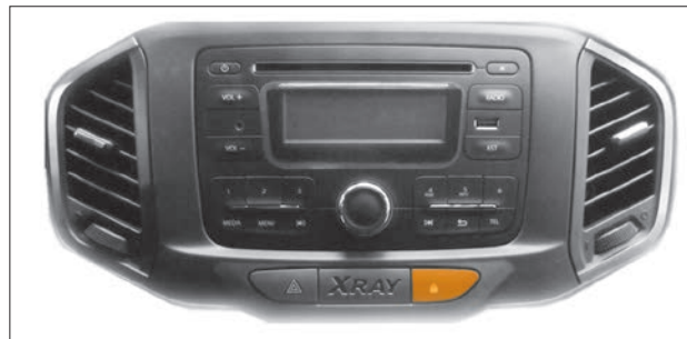
Рис. 1.10. Кнопка выключателя блокировки двери
