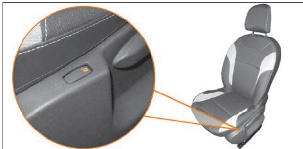
Рис. 2.4. Выключатель подогрева передних сидений (с фиксированными положениями)
