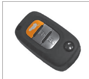
Рис. 1.5. Кнопка открывания двери задка пульта дистанционного управления
