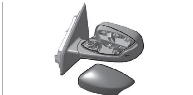
Рис. 8.19. Снятие накладки зеркала
