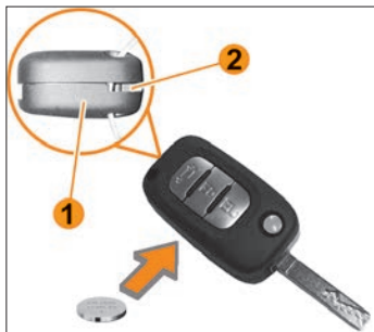
Рис. 8.10. Замена элемента питания ПДУ
