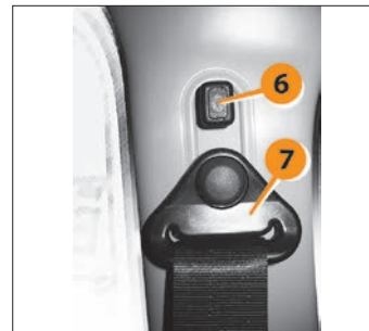
Рис. 2.11. Регулировка переднего ремня безопасности
