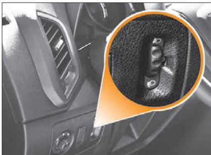
Рис. 3.15. Колесико переключателя электрокорректора угла наклона света фар
