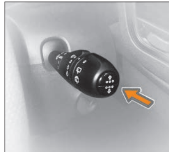
Рис. 3.8. Кнопки управления бортовым компьютером на переключателе стеклоочистителей
