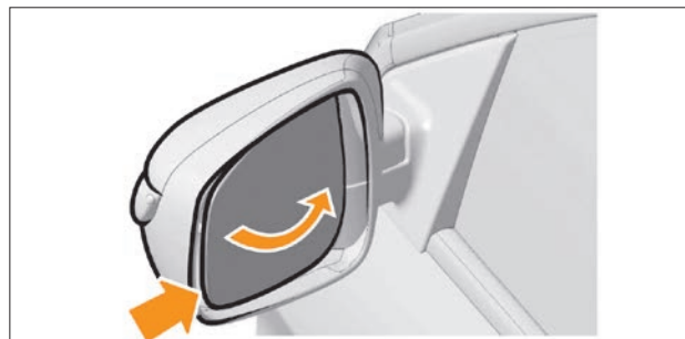
Рис. 8.15. Зеркальный элемент в максимальном боковом положении
