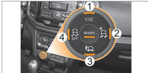
Рис. 4.7. Переключатель режимов движения системы электронного контроля устойчивости
