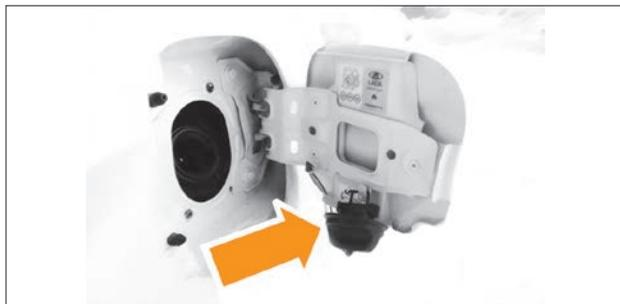
Рис. 4.9. Расположение пробки топливного бака при заправке
