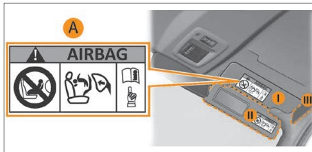
Рис. 2.17. Предупреждающие таблички на правом противосолнечном козырьке
