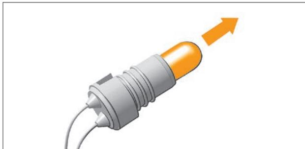
Рис. 8.21. Извлечение лампы
