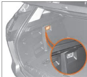
Рис. 7.4. Плафон освещения багажного отделения
