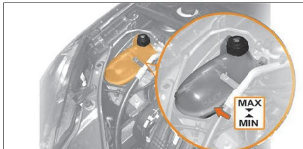
Рис. 8.6. Расширительный бачок
