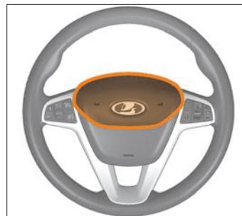
Рис. 3.10. Активация звукового сигнала
