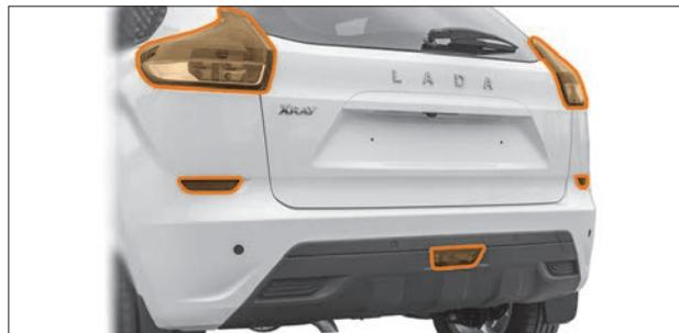
Рис. 9.11. Рассеиватели световых приборов задние
