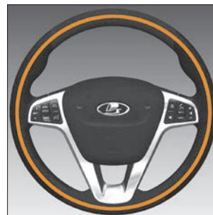
Рис. 3.11.4. Зоны обогрева рулевого колеса
