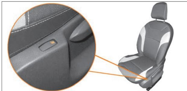
Рис. 2.4.1. Выключатель подогрева передних сидений (с фиксированными положениями)
