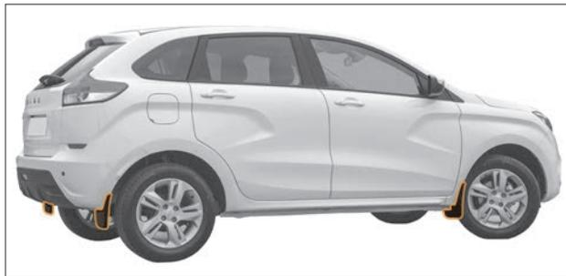
Рис. 8.30. Щитки переднего и заднего крыла
