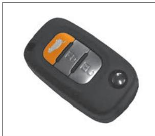
Рис. 1.5. Кнопка открывания двери задка пульта дистанционного управления
