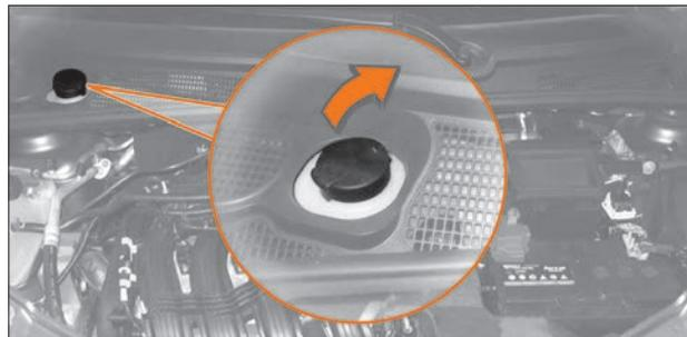
Рис. 8.8. Бачок стеклоомывателя
