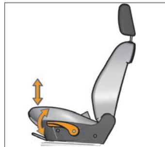
Рис. 2.3.1. Регулировка сиденья по высоте
