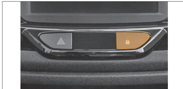
**Рис. 1.10. Кнопка выключателя блокировки дверей**
