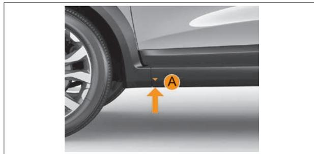
Рис. 9.5.4. Метка для установки домкрата в модификации Cross
