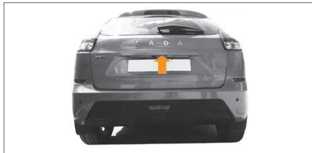
Рис. 1.9. Кнопка открывания двери задка
