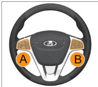
Рис. 3.11.1 Рулевое колесо с дополнительными органами управления (в варианном исполнении)
