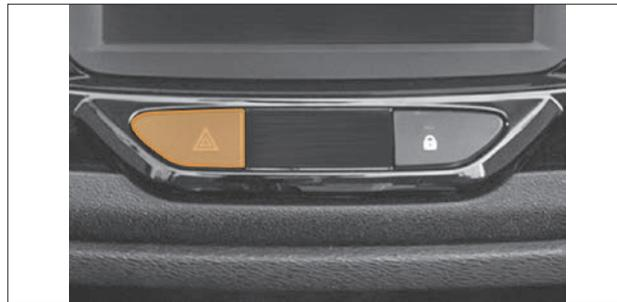
Рис. 1.12. Кнопка выключателя аварийной световой сигнализации
