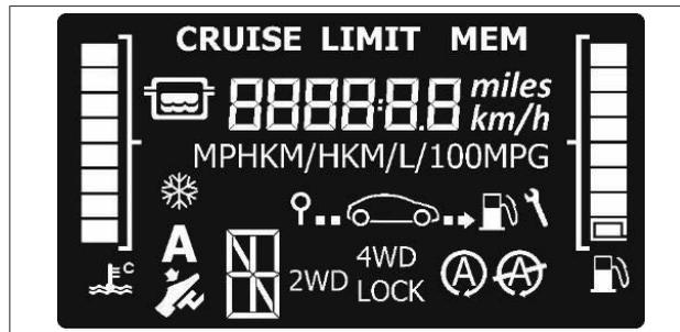
Рис. 3.8.2. Дисплей бортового компьютера (в варианном исполнении)
