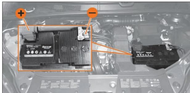
Рис. 8.9. Аккумуляторная батарея
