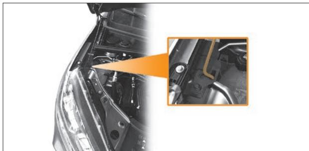
Рис. 8.3.2. Упор капота
