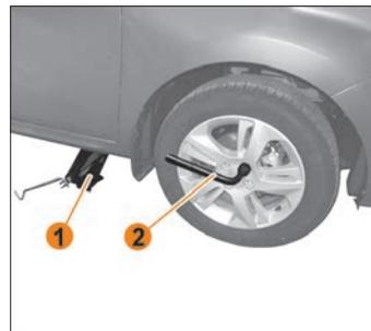
Рис. 9.5.1. Снятие колеса
