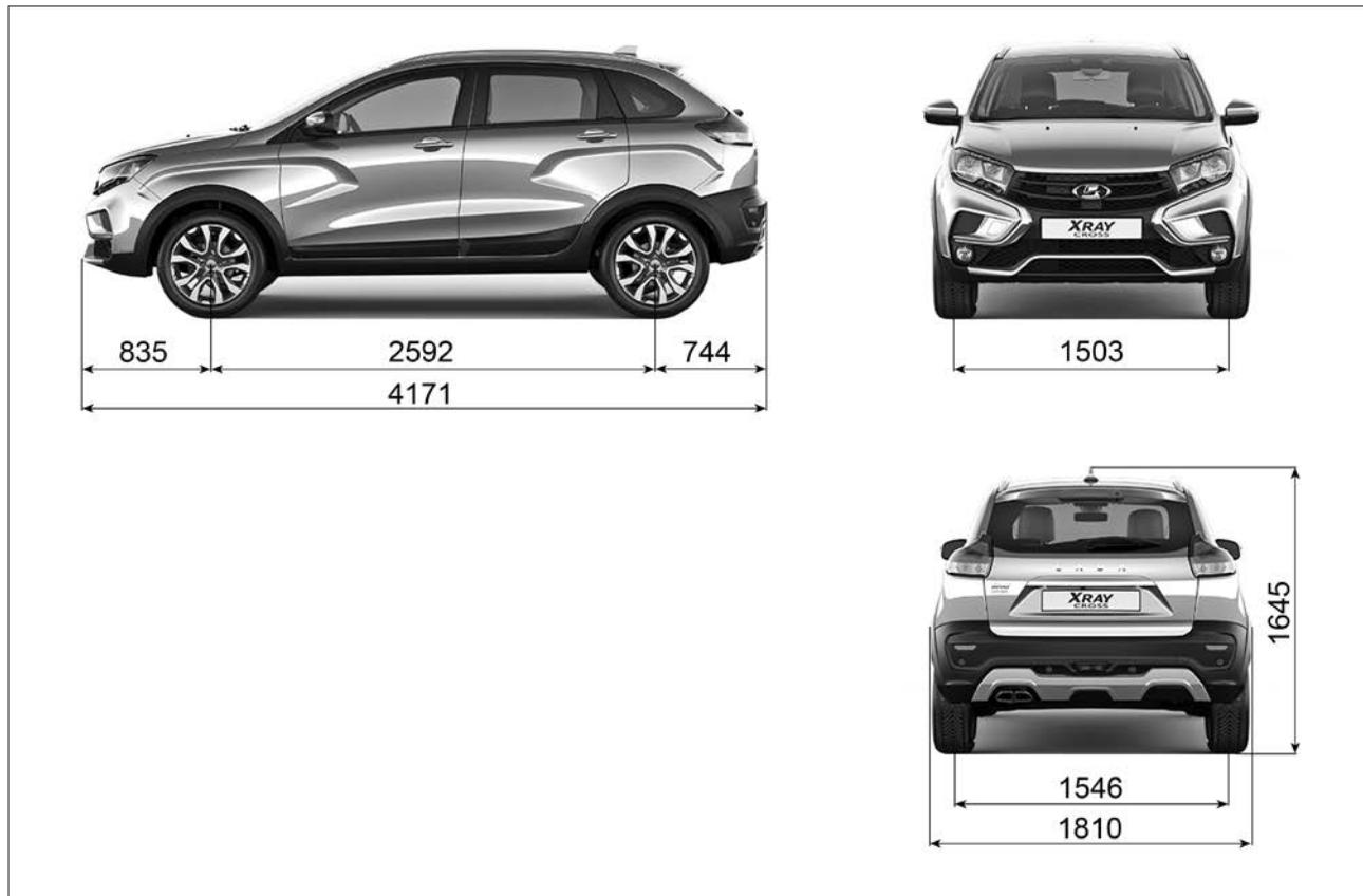
Рис. 10.4. Габаритные (справочные) размеры автомобиля XRAY Cross
