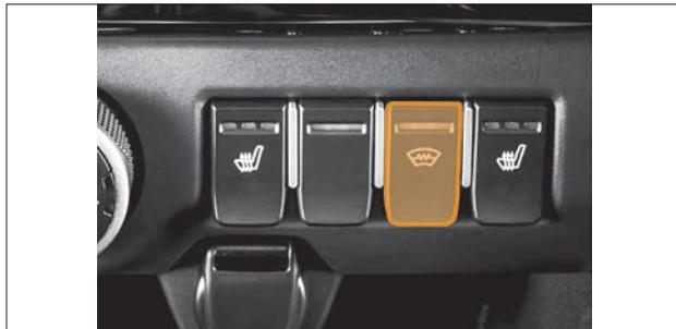
Рис. 6.5. Выключатель обогрева ветрового стекла
