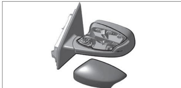
Рис. 8.19. Снятие накладки зеркала
