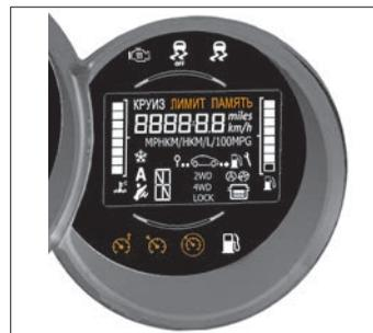
Рис. 5.4. Дисплей комбинации приборов
