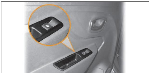
Рис. 1.22. Кнопка управления электрического стеклоподъемника задней двери (в вариантном исполнении)
