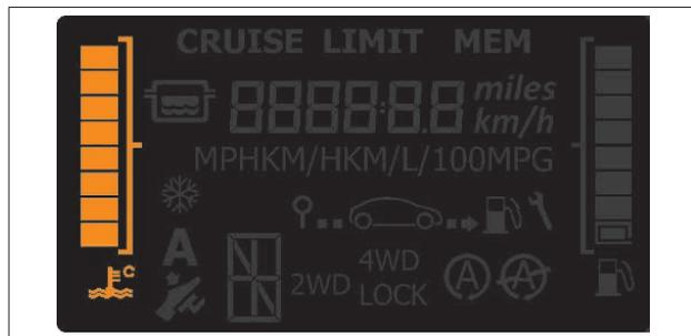
**Рис. 3.8.3. Индикатор температуры охлаждающей жидкости (в варианном исполнении)**
