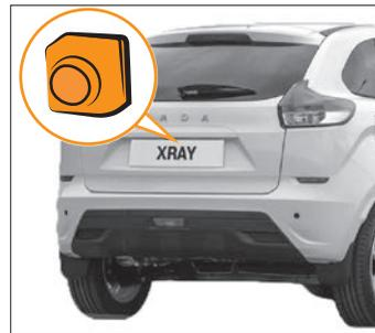
Рис. 5.7. Камера заднего вида
