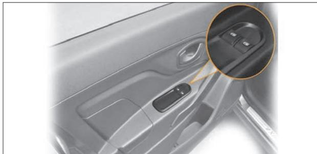
Рис. 1.18. Блок переключателей на двери водителя
