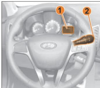
Рис. 3.6. Кнопки управления бортовым компьютером на переключателе стеклоочистителей
