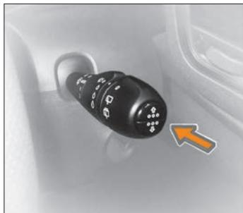
Рис. 3.7. Кнопки управления бортовым компьютером на переключателе стеклоочистителей
