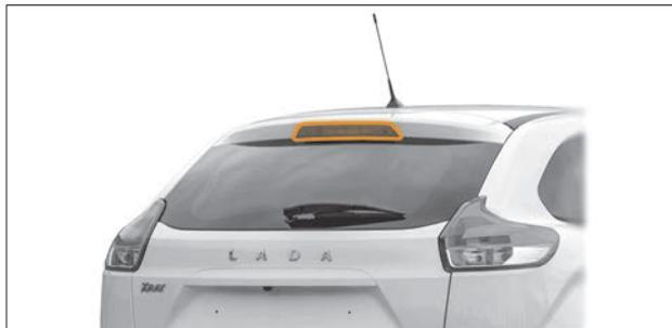
Рис. 8.23. Дополнительный сигнал торможения
