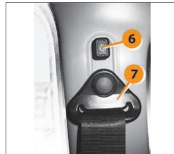
Рис. 2.11. Регулировка переднего ремня безопасности
