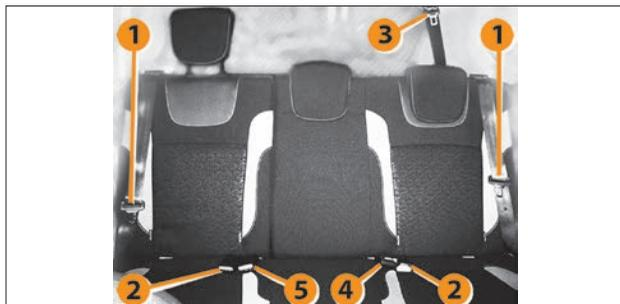
Рис. 2.10. Задние ремни безопасности
