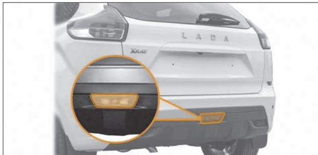
Рис. 8.14. Задний противотуманный фонарь
