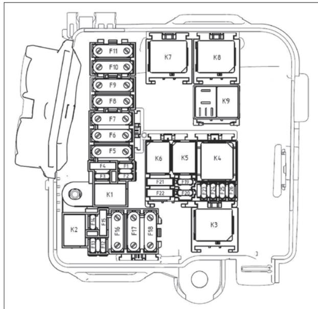
Рис. 8.28. Блок предохранителей и реле моторного отсека
