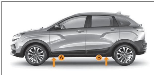
Рис. 9.5.3. Места для установки домкрата в модификации Cross
