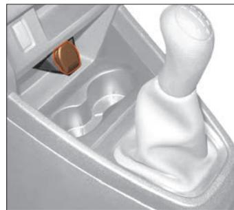
**Рис. 7.5.1. Розетка для подключения дополнительного электрооборудования**
