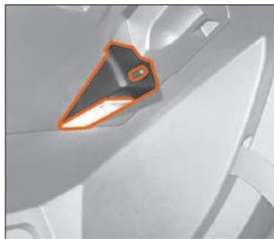
Рис. 7.3. Плафон освещения вещевого ящика
