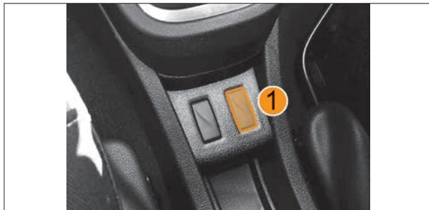
Рис. 4.6.3. Выключатель «ESC OFF» на тоннеле пола
