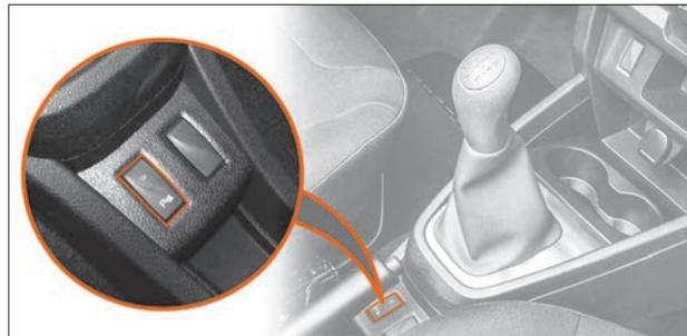
Рис. 5.6. Выключатель СБП
