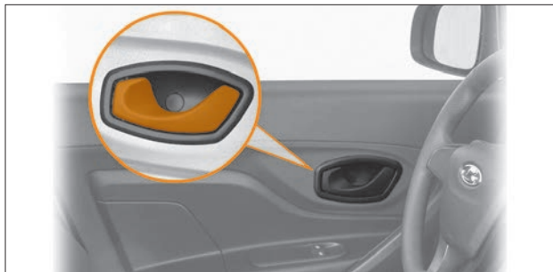
Рис. 1.14. Ручка для отпирания дверей из салона
