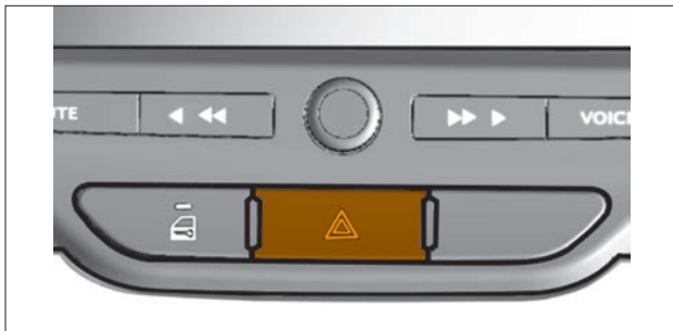
Рис. 1.12.2. Кнопка выключателя аварийной световой сигнализации (в варианном исполнении)
