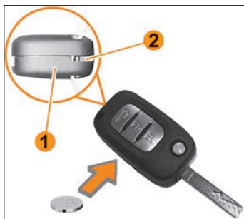
Рис. 8.10. Замена элемента питания ПДУ
