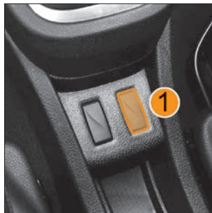
Рис. 4.6.3. Выключатель «ESC OFF» автомобиля LADA XRAY Cross (в варианном исполнении)
