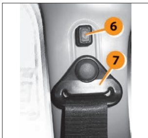
Рис. 2.11. Регулировка переднего ремня безопасности
