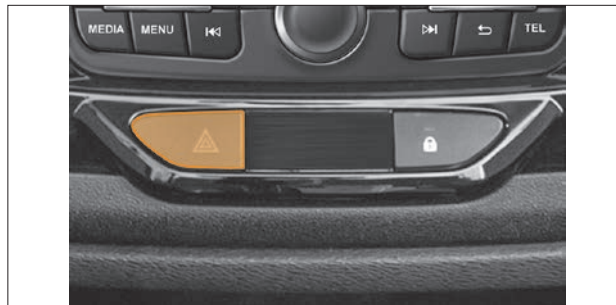
Рис. 1.12.1. Кнопка выключателя аварийной световой сигнализации (в варианном исполнении)
