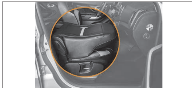
Рис. 2.3.3. Правое переднее сиденье в сложенном положении (в варианном исполнении)
