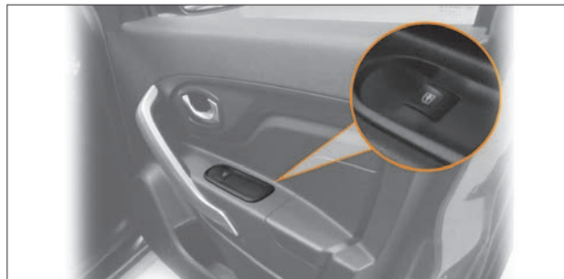
Рис. 1.21. Кнопка управления электрическим стеклоподъемником двери переднего пассажира
