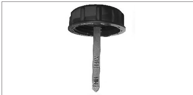
Рис. 8.7.2. Крышка бачка гидроусилителя рулевого управления со щупом
