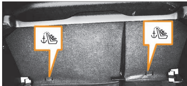
Рис. 2.18. Кронштейны для верхнего страховочного ремня ISOFIX
