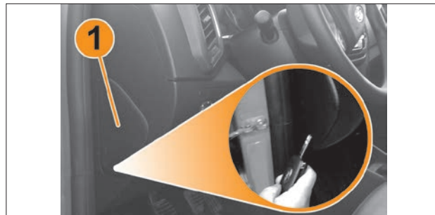
Рис. 8.29 Демонтаж крышки блока предохранителей и реле салона
