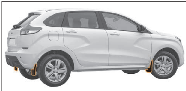
Рис. 8.30. Щитки переднего и заднего крыла
