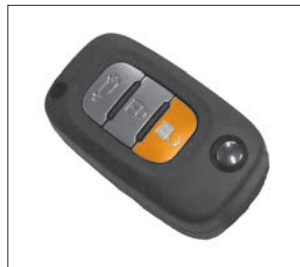
Рис. 1.3. Кнопка «РАЗБЛОКИРОВКА» пульта дистанционного управления
