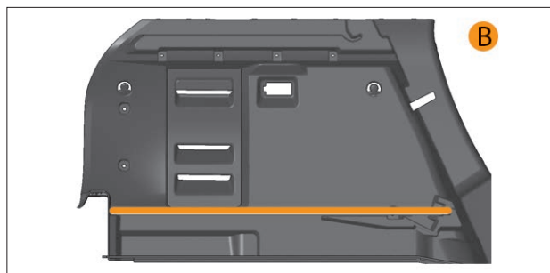
Рис. 9.8.2. Верхнее положение съемного пола (вид сбоку)
