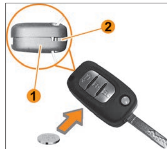
Рис. 8.10. Замена элемента питания ПДУ
