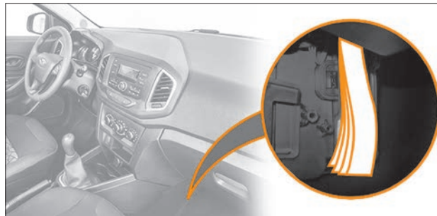
Рис. 6.6. Замена фильтра салона
