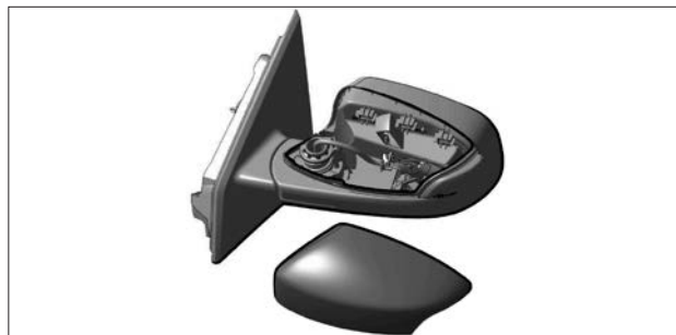
Рис. 8.19. Снятие накладки зеркала
