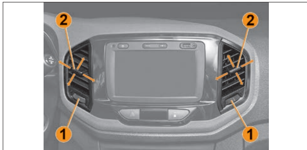
Рис. 6.2. Регулировка воздушных потоков через вентиляционные сопла
