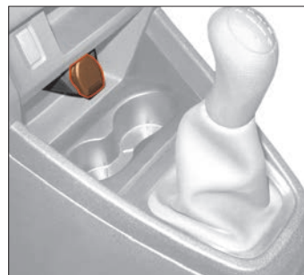
Рис. 7.5.1. Розетка для подключения дополнительного электрооборудования
