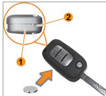
Рис. 8.10. Замена элемента питания ПДУ
