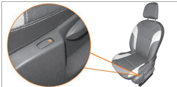
Рис. 2.4. Выключатель подогрева передних сидений (с фиксированными положениями)
