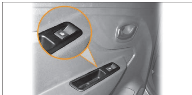
Рис. 1.22. Кнопка управления электрического стеклоподъемника задней двери (в варианном исполнении)
