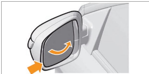
Рис. 8.15. Зеркальный элемент в максимальном боковом положении
