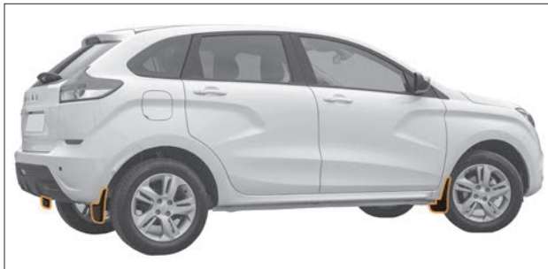
Рис. 8.30. Щитки переднего и заднего крыла
