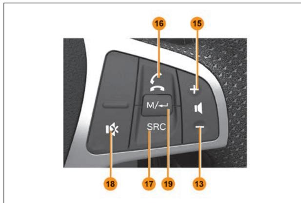
Рис. 2. Органы управления аудиосистемы на рулевом колесе
