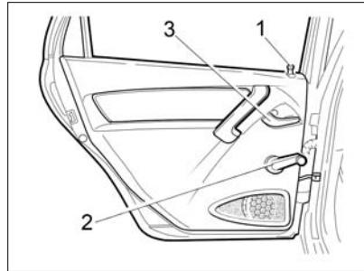
Рис. 7б. Задняя дверь с динамиком (в вариантом исполнении)
