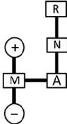
**Рис. 48. Схема рычага переключения передач**
