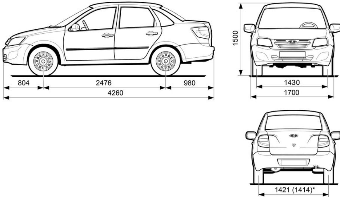
**Рис. 64а. Габаритные (справочные) размеры автомобиля 2190 (седан)**
