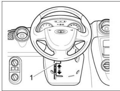
**Рис. 12. Регулировка положения рулевого колеса
