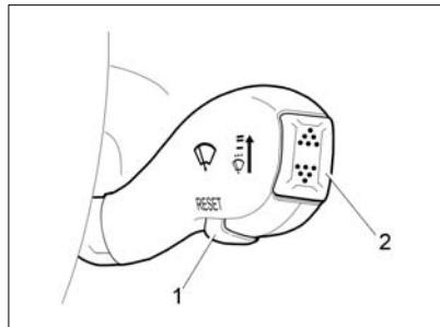
Рис. 31. Кнопки управления бортовым компьютером на рычаге переключателя стеклоочистителей (в вариантом исполнении)
