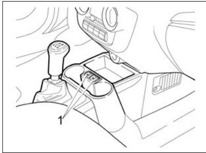
Рис. 9б. Выключатели обогрева передних сидений
