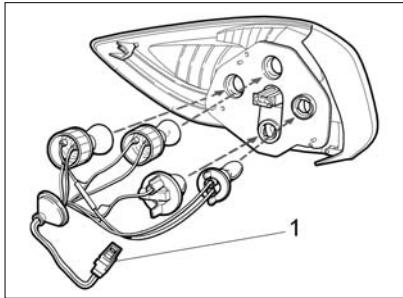
Рис. 59б. Задний фонарь автомобиля с кузовом «лифтбек»
