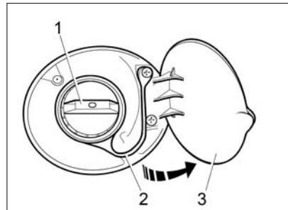
**Рис. 27. Пробка топливного бака**
