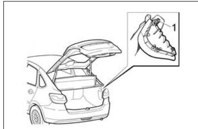
Рис. 59в. Снятие заглушки опоры полки
