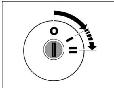
Рис. 36. Выключатель зажигания
