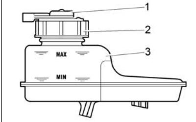
**Рис. 49. Бачок гидропривода тормозов**
