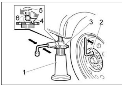
**Рис. 53б. Подъем автомобиля при замене колес**
