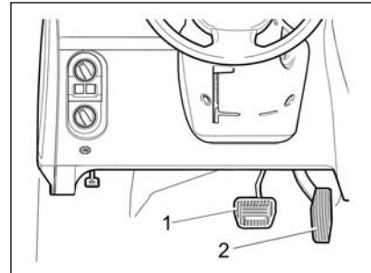
**Рис. 37в. Педали при автоматической коробке передач**
