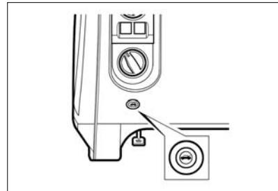
Рис. 26а. Выключатель привода
