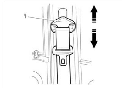
**Рис. 14б. Регулировка ремня безопасности
