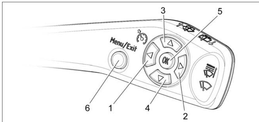
Рис. 32. Клавиши управления круиз-контролем и ограничителем скорости
