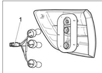
Рис. 59а. Задний фонарь автомобиля с кузовом «седан»
