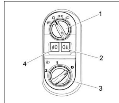
Рис. 31а. Модуль управления светотехникой и корректором ближнего света фар
