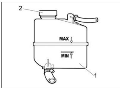
Рис. 46. Расширительный бачок
