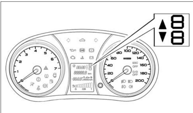
Рис. 30. Функция подсказчика переключения передач в ЖКИ комбинации приборов
