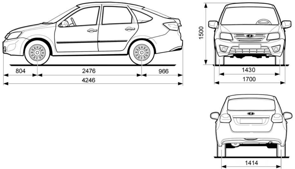
Рис. 64б. Габаритные (справочные) размеры автомобиля 2191 (лифтбек)
