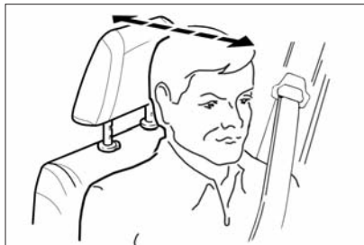
Рис. 11б. Оптимальное положение подголовника
