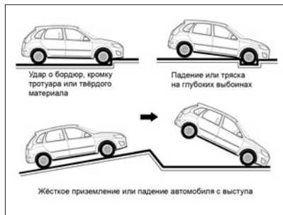
Рис. 17б. Примеры ситуаций со срабатыванием СНПБ
