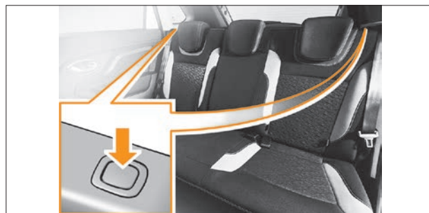
Рис. 2.7. Разблокировка спинки заднего сиденья
