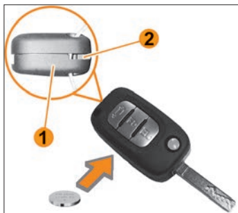
Рис. 8.10. Замена элемента питания ПДУ
