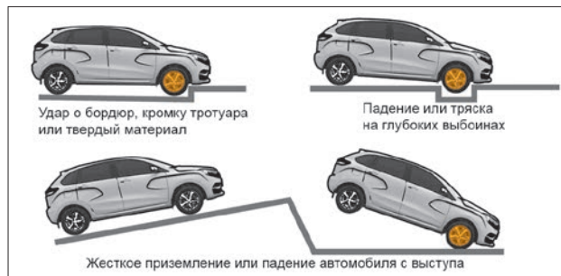
Рис. 2.13. Примеры ситуаций срабатывания подушек безопасности
