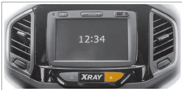
Рис. 1.10 Кнопка выключателя блокировки двери (в варианном исполнении).
