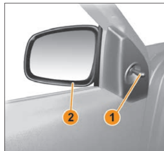
Рис. 3.12. Наружные зеркала заднего вида с ручной регулировкой
