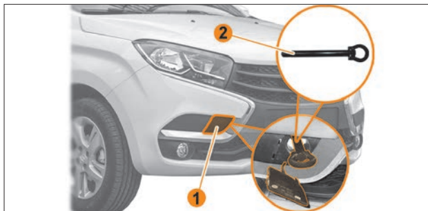
Рис. 9.6. Передняя буксировочная проушина
