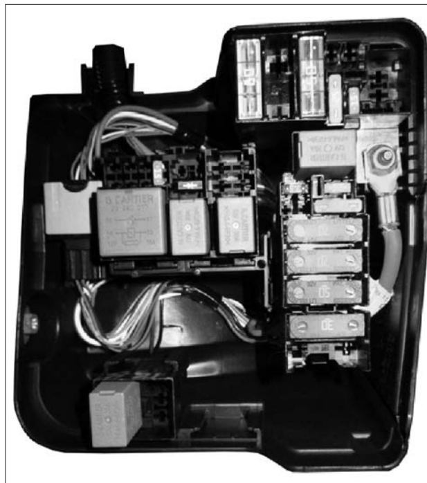
Рис. 8.28. Монтажный блок моторного отсека
