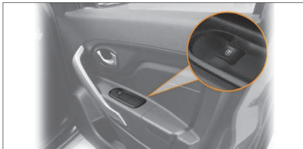
Рис. 1.19. Кнопка управления электрическим стеклоподъемником двери переднего пассажира
