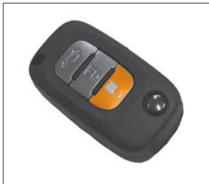
Рис. 1.3. Кнопка «РАЗБЛОКИРОВКА» пульта дистанционного управления
