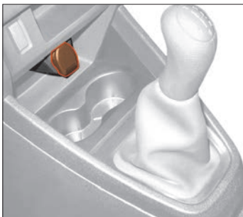
Рис. 7.3. Розетка для подключения дополнительного электрооборудования
