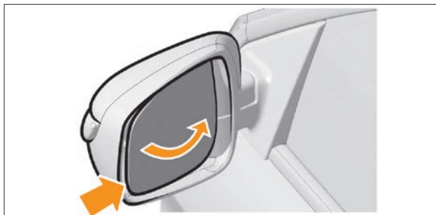
Рис. 8.15. Зеркальный элемент в максимальном боковом положении
