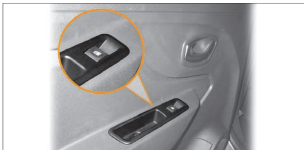
Рис. 1.20. Кнопка управления электрического стеклоподъемника задней двери (в вариантном исполнении)
