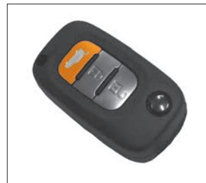
Рис. 1.5. Кнопка открывания багажника пульта дистанционного управления
