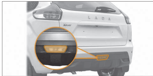
Рис. 8.14. Задний противотуманный фонарь
