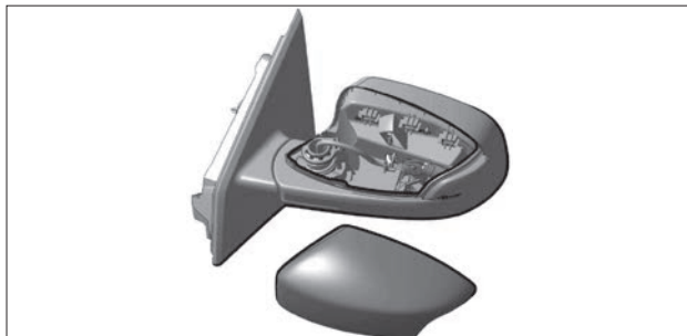
Рис. 8.19. Снятие накладки зеркала
