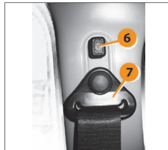
Рис. 2.10. Регулировка переднего ремня безопасности
