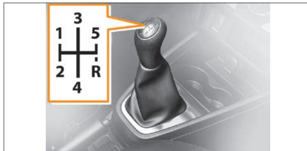
Рис. 4.1. Рычаг переключения механической коробки передач
