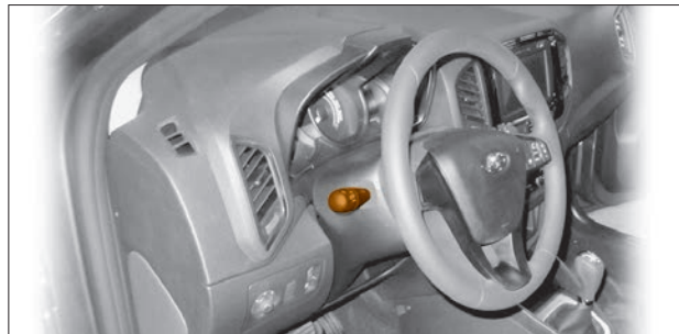
Рис. 1.22. Переключатель световой сигнализации
