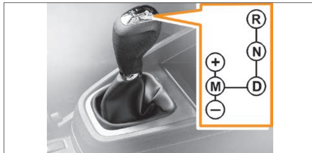
Рис. 4.2. Селектор автоматизированной трансмиссии
