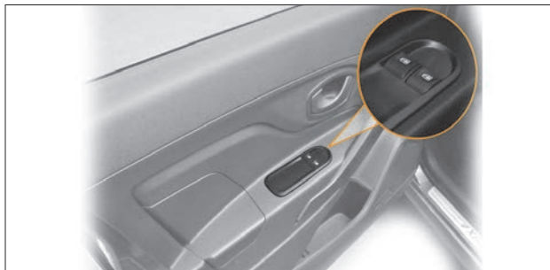
Рис. 1.16. Блок переключателей на двери водителя
