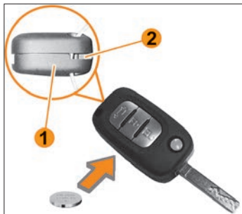
Рис. 8.10. Замена элемента питания ПДУ
