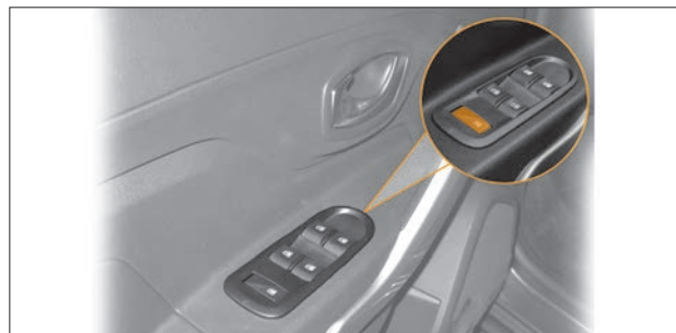
Рис. 1.18. Кнопка блокировки стеклоподъемников задних дверей (в вариантном исполнении)
