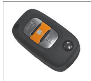
Рис. 1.4 Кнопка «БЛОКИРОВКА» пульта дистанционного управления
