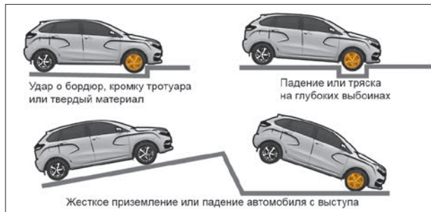
Рис. 2.13. Примеры ситуаций срабатывания подушек безопасности
