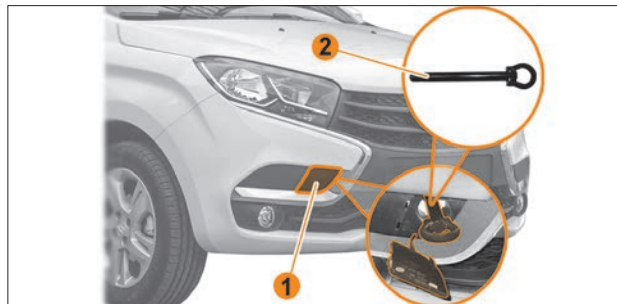
Рис. 9.6. Передняя буксировочная проушина
