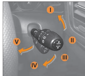
Рис. 1.28. Положения рычага управления омывом и очисткой стекол
