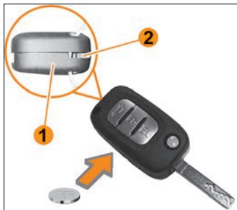
Рис. 8.10. Замена элемента питания ПДУ
