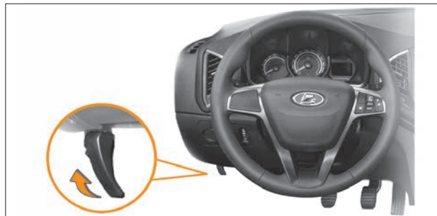
Рис. 8.1. Рукоятка отпирания капота
