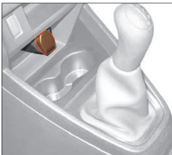
Рис. 7.3. Розетка для подключения дополнительного электрооборудования
