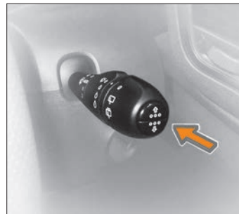
Рис. 3.8. Кнопки управления бортовым компьютером на переключателе стеклоочистителей
