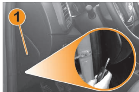
Рис. 8.29 Демонтаж крышки блока предохранителей и реле салона
