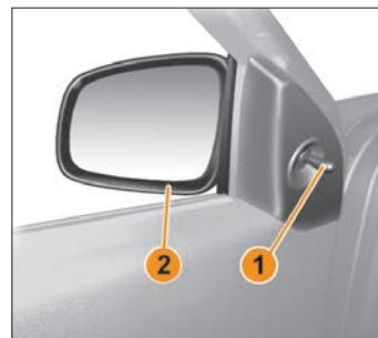
Рис. 3.12. Регулировка наружных зеркал заднего вида с механическим приводом
