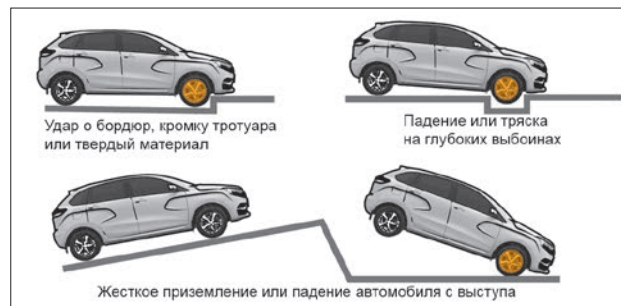
Рис. 2.14. Примеры ситуаций срабатывания подушек безопасности
