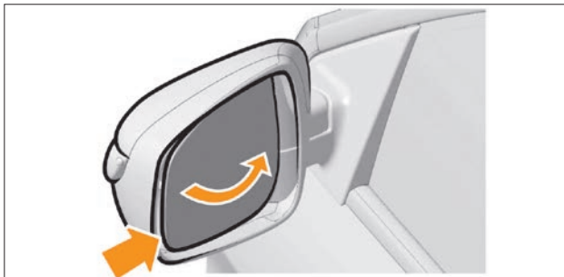
Рис. 8.15. Зеркальный элемент в максимальном боковом положении
