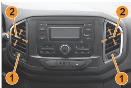
Рис. 6.2. Регулировка воздушных потоков через вентиляционные сопла
