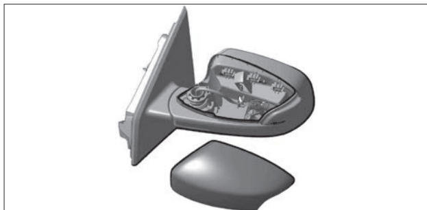
Рис. 8.19. Снятие накладки зеркала
