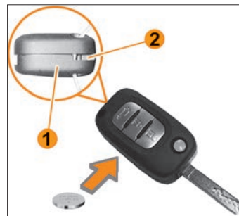
Рис. 8.10. Замена элемента питания ПДУ
