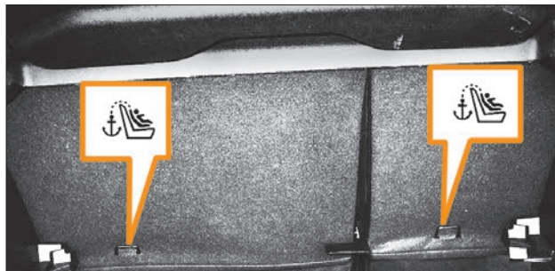
Рис. 2.17. Кронштейны для верхнего страховочного ремня ISOFIX
