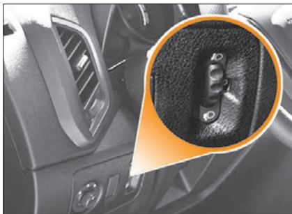
Рис. 3.15. Колесико переключателя электрокорректора угла наклона света фар
