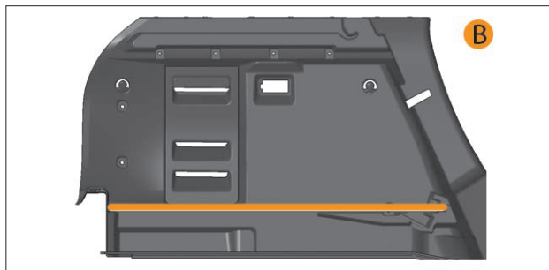
Рис. 9.8.2. Верхнее положение съемного пола (вид сбоку)
