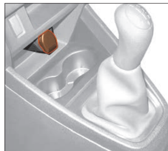
Рис. 7.5. Розетка для подключения дополнительного электрооборудования
