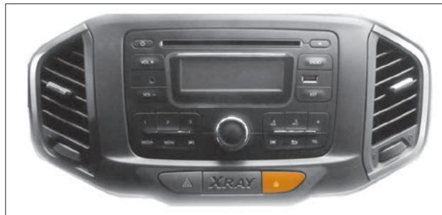
Рис. 1.10. Кнопка выключателя блокировки двери
