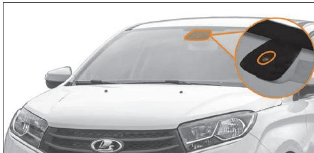
Рис. 1.27. Датчик дождя и света
