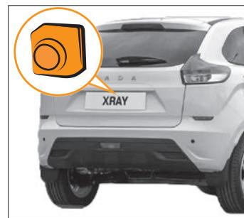
Рис. 5.4. Камера заднего вида
