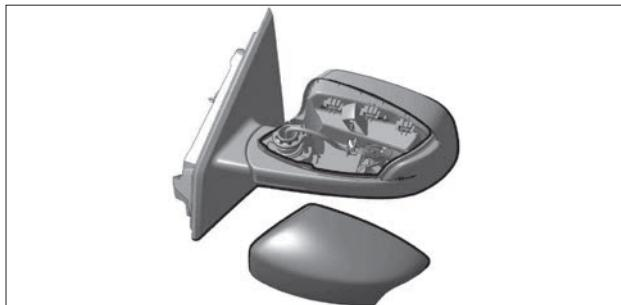
Рис. 8.19. Снятие накладки зеркала
