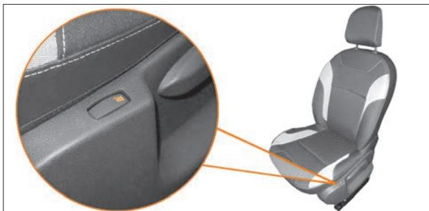
Рис. 2.4. Выключатель подогрева передних сидений
