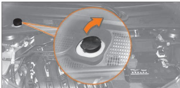
Рис. 8.8. Бачок стеклоомывателя
