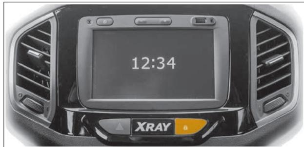
**Рис. 1.11 Кнопка выключателя блокировки двери (в вариантом исполнении)**
