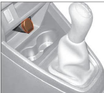
Рис. 7.3. Розетка для подключения дополнительного электрооборудования
