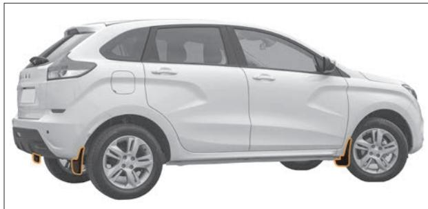
Рис. 9.10. Щитки переднего и заднего крыла
