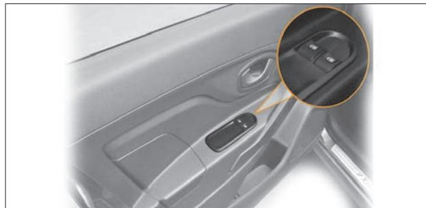
Рис. 1.17. Блок переключателей на двери водителя
