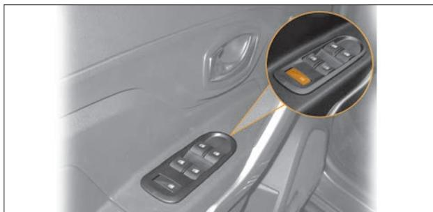
Рис. 1.19. Кнопка блокировки стеклоподъемников
