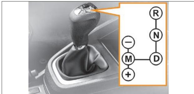
Рис. 4.2. Селектор автоматизированной трансмиссии
