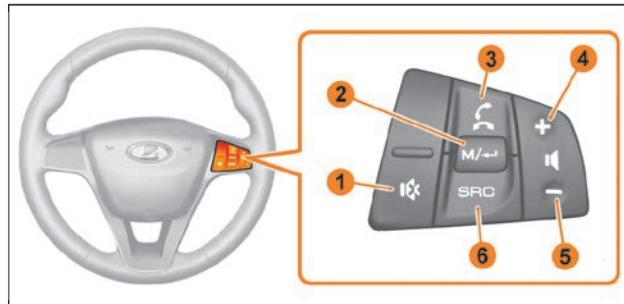
Рис. 3.11. Органы управления мультимедийным оборудованием на рулевом колесе
