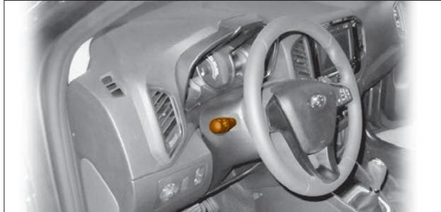
Рис. 1.23. Переключатель световой сигнализации
