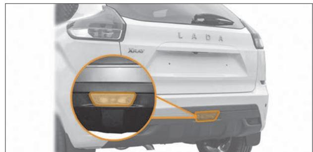
Рис. 8.14. Задний противотуманный фонарь
