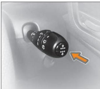
**Рис. 3.8. Кнопки управления бортовым компьютером на переключателе стеклоочистителей**
