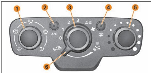
Рис. 6.2. Панель управления климатической системой с ручным управлением и кондиционером
