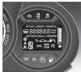
Рис. 3.7. Дисплей бортового компьютера
