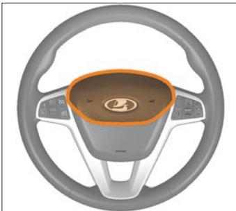
Рис. 3.10. Активация звукового сигнала
