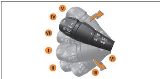
Рис. 1.24. Положения рычага переключателя световой сигнализации
