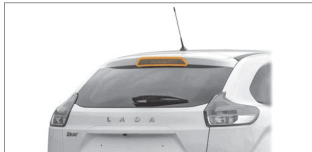
Рис. 8.23. Дополнительный сигнал торможения
