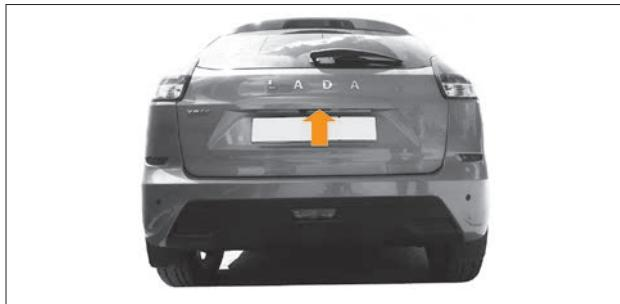
Рис. 1.9. Кнопка открывания двери задка
