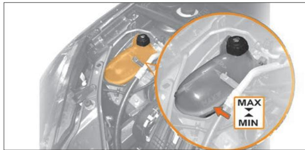
Рис. 8.6. Расширительный бачок
