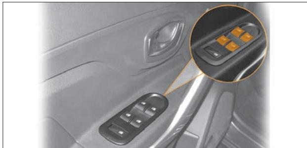
Рис. 1.18. Блок переключателей на двери водителя
