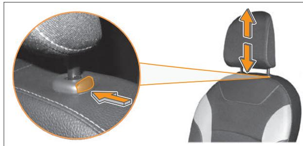
Рис. 2.6. Регулировка высоты
