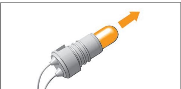
Рис. 8.21. Извлечение лампы
