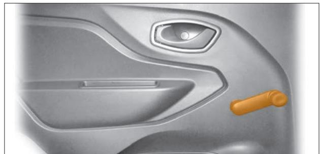
Рис. 1.22. Ручка механического стеклоподъемника
