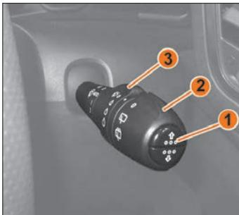
Рис. 1.28. Рычаг управления омывом и очисткой стекол
