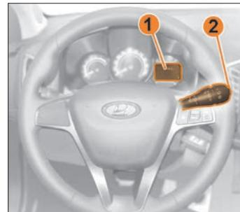
Рис. 3.6. Кнопки управления бортовым компьютером на переключателе стеклоочистителей
