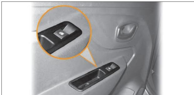
Рис. 1.21. Кнопка управления электрического стеклоподъемника задней двери (в вариантом исполнении)
