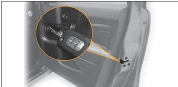
Рис. 1.15. Рычаг для запирания двери при деактивированных электрических приводах замков
