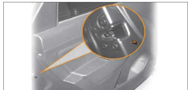
Рис. 1.16. Рычаг для блокировки открывания задней двери изнутри (детская блокировка)
