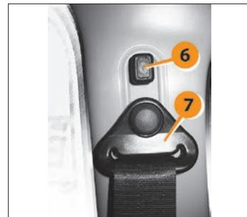
Рис. 2.10. Регулировка переднего ремня безопасности
