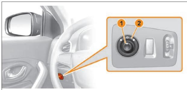
Рис. 3.13. Регулировка зеркал заднего вида с электроприводом (*в вариантом исполнении*).
