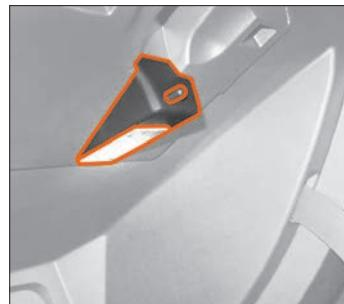
Рис. 7.6. Плафон освещения вещевого ящика
