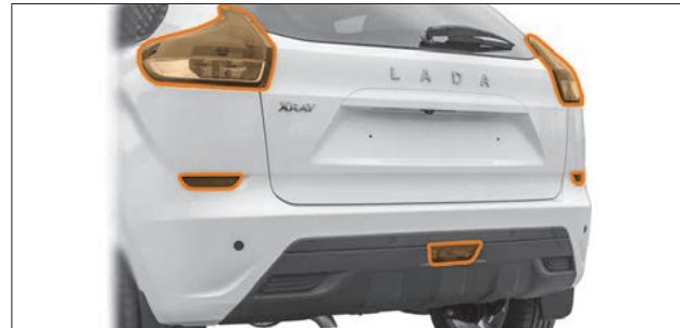
Рис. 9.12. Рассеиватели световых приборов задние
