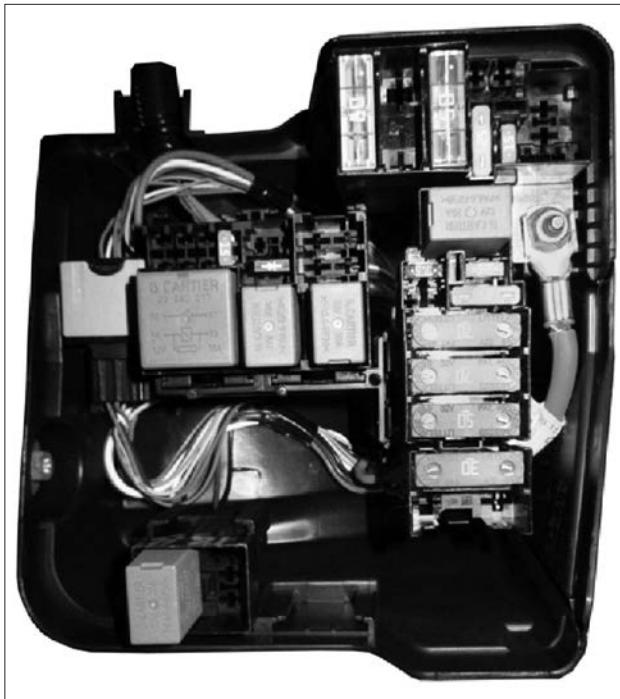
Рис. 8.28. Монтажный блок моторного отсека
