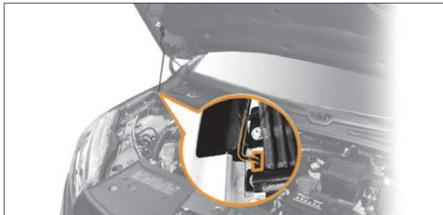
Рис. 8.3. Упор капота
