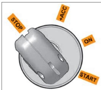
Рис. 1.7. Выключатель зажигания
