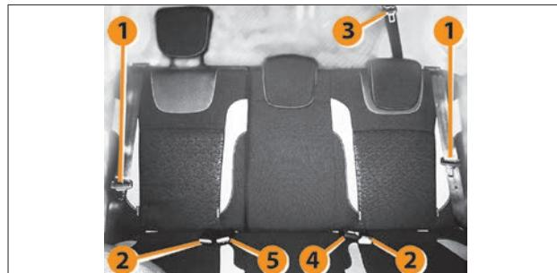
Рис. 2.9. Задние ремни безопасности
