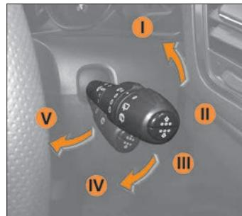
Рис. 1.29. Положения рычага управления омывом и очисткой стекол
