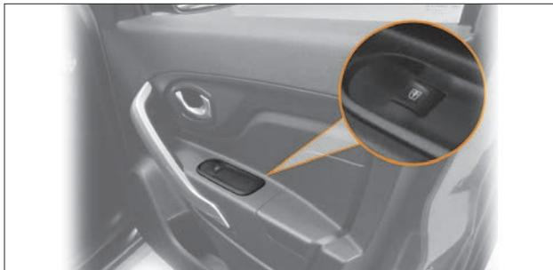
Рис. 1.20. Кнопка управления электрическим стеклоподъемником двери переднего пассажира
