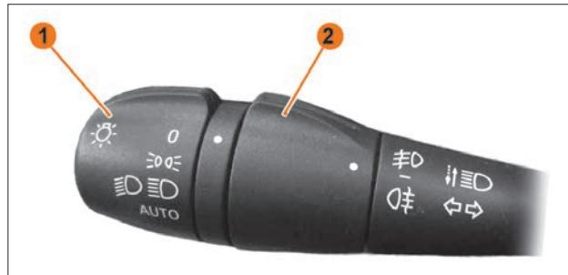
Рис. 1.25. Кольца управления на рычаге переключателя
